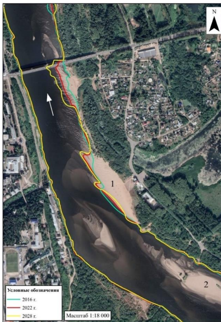
Рис. 1. Положение русла за 2013 г. (зеленый цвет) и 2022 г. (красный цвет) и прогнозное положение русла на 2031 г. (желтый цвет)
