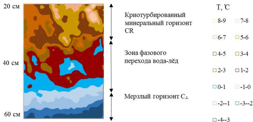
Рис. 1. Тепловой портрет фрагмента стенки почвенного разреза криозёма типичного в Норильском промышленном районе.
