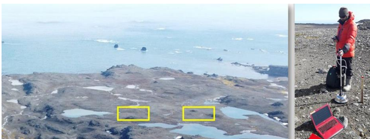
Рис.1. Расположение точек мониторинга потоков парниковых газов ( \text{CH}_4 , \text{CO}_2 ), слева, отмечено желтым; измерение потоков парниковых газов газоанализатором Picarro G4301, справа.
