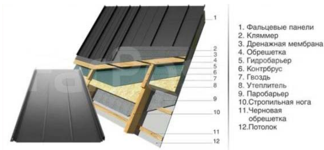
Рис. 9 Состав фальцевой кровли
