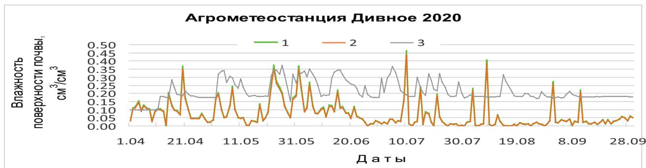
Рисунок 7. Влажность поверхности почвы, определенная по данным ASCAT (1) и рассчитанная с помощью модели по наземным данным при задании почвенных характеристик для суглинков (2) и тяжелой глины (3). Агromетеорологическая станция Дивное (Ставропольский край). Сезон вегетации 2020 г.
