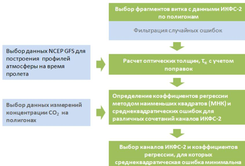
Рис. 1. Алгоритм выбора каналов и расчетов коэффициентов регрессии.
