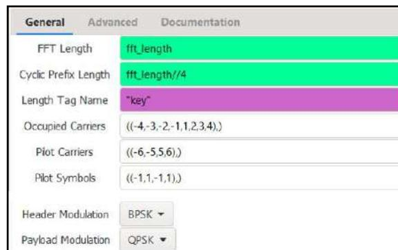
Рис. 5. Параметры блока «OFDM Transmitter».
