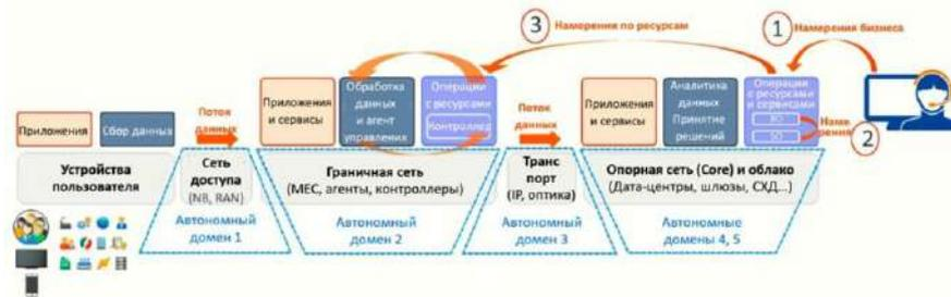
Рис. 1. Процесс работы автономной сети оператора связи (источник: ETSI).
