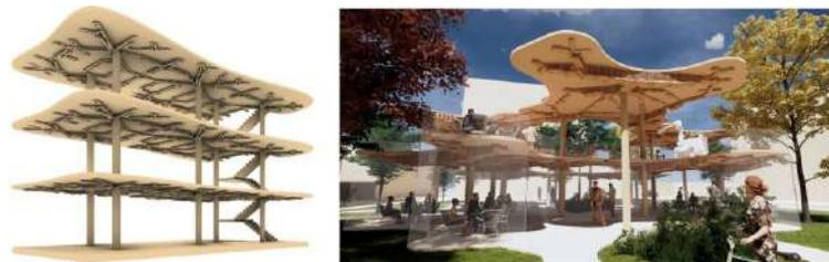
Рис. 3. Расположение балок деревянного павильона после оптимизации.
