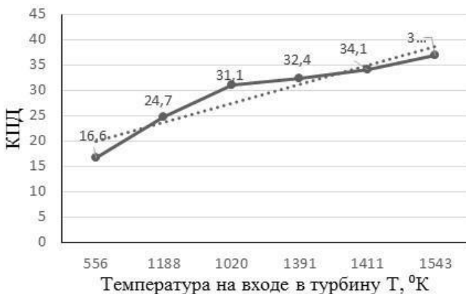
Рис. 1. Зависимость КПД от температуры на входе в турбину
