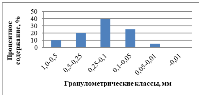
Рис.3. Процентное распределение гранулометрических классов в пробе 12 и 13
