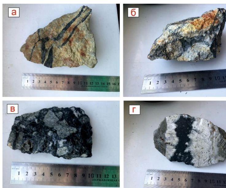
Рис. 1. Проявление серебро-сульфидно-полиметаллической стадии: а – кварц-сульфидные прожилки, б, в – кварц-сульфидный цемент гидротермальных брекчий, г – полосы и просечки в жилах дорудных стадий.
