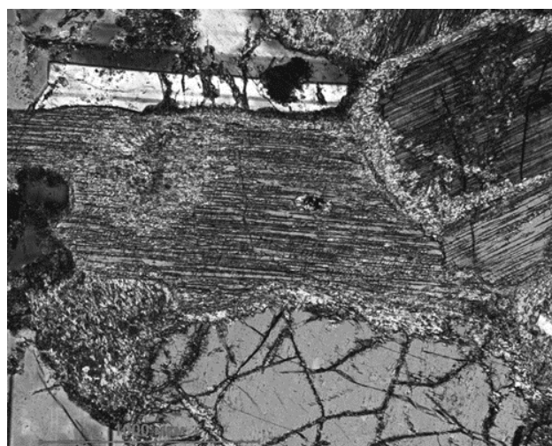
Рис.3. Габбро. Фрагмент шлифа под микроскопом с анализатором.
