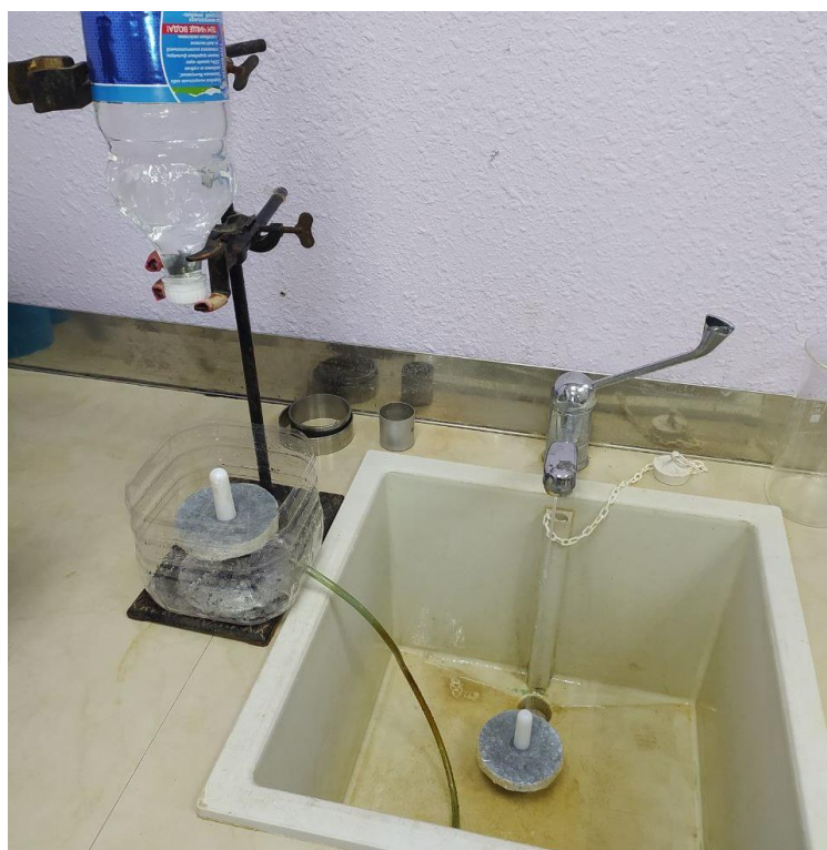
Рис. 1. Установка моделирования свай под ангидритами (слева изображен образец № 2, справа – № 1)
