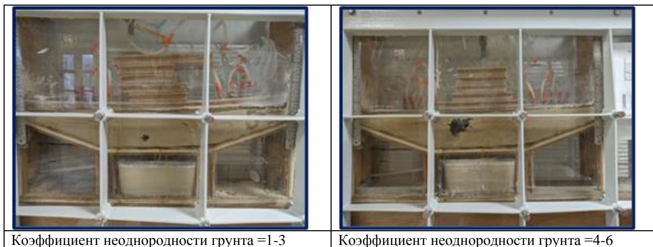
Рис. 2. Внешний вид устройства с моделируемым грунтом
