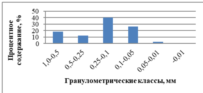
Рис.2. Процентное распределение гранулометрических классов в пробе 4 и 6
