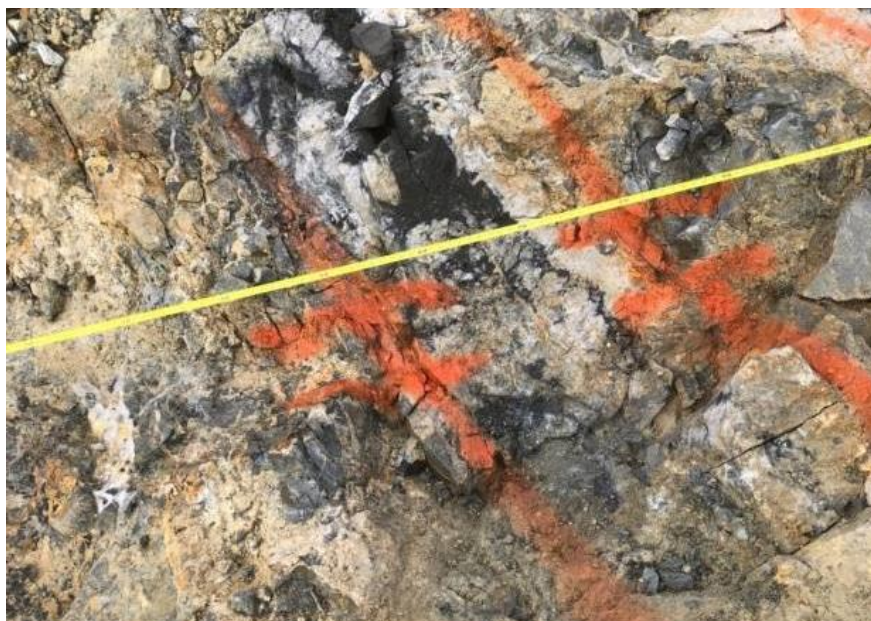
Рис. 3. Кварц-адуляровая жила с сульфидной минерализацией (пробирный анализ данной бороздовой пробы: Au – 17 г/т, Ag – 2511 г/т)
