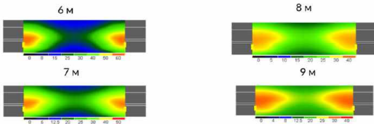
Рис. 2. Зависимость неоднородности освещения дорожного полотна от высоты прибора
