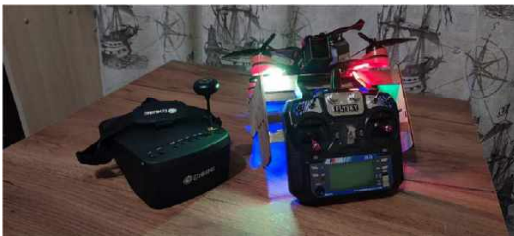
Рис. 1. Фотография собранного в процессе проектной деятельности образца квадрокоптера с необходимыми для его управления средствами телеметрии
