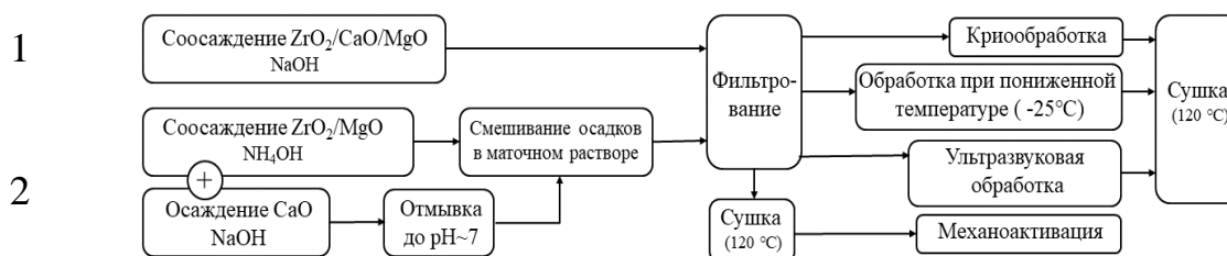
Рисунок 1. Схема синтеза методом совместного (1) и параллельного (2) осаждения гидроксидов.
