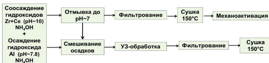
Рисунок 1. Схема синтеза ксерогелей методом совместного осаждения гидроксидов с последующей обработкой
