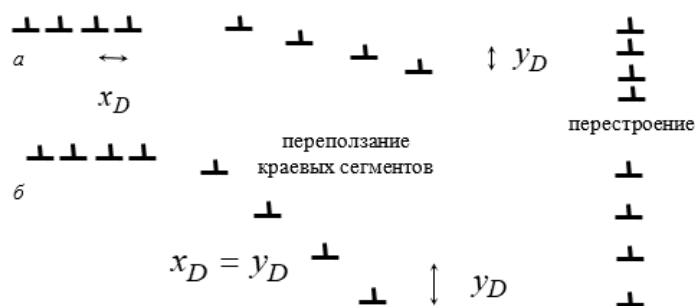
Рис. Схема перестроения скоплений в малоугловые стенки наклона. а – силовое перестроение под действием динамического напряжения, б – перестроение после достижения неустойчивого состояния равновесия
