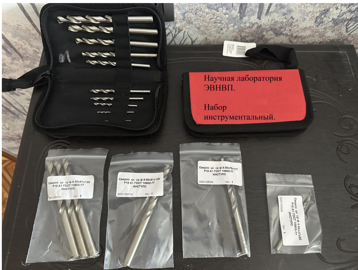
Рисунок 1 – Инструментальный набор сверл из стали P18. Поверхность сверл упрочнена покрытием из карбида вольфрама, полученным методом электровзрывного напыления
