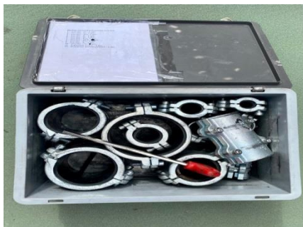
Набор бандажей для труб различного диаметра
