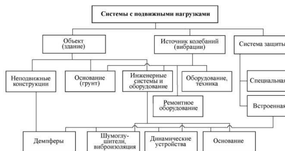
Рисунок 1 – Структура системы с подвижной нагрузкой и защитой от вибрации
