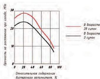
Рисунок 2 – Зависимость прочности на изгиб от содержания цемента М500
