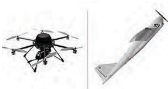
Рисунок 2 – Беспилотные транспортные средства, контролируемые по радио. Слева - беспилотный вертолет «Колибри», а справа - беспилотник «Орлан-10»
