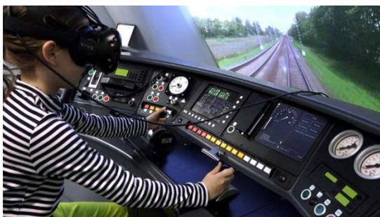
Рисунок 2 - Пример симулятора, использующего виртуальную реальность.
