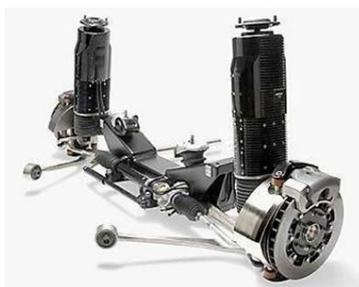
Рисунок 4-Электромагнитная подвеска на автомобиле
