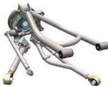
Рисунок 1-Многорычажная подвеска автомобиля
