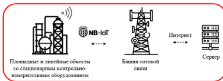
Рисунок 2. Беспроводная передача данных по технологии NB-IoT.
