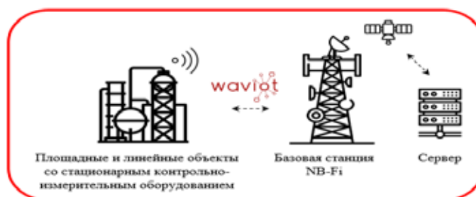
Рисунок 4. Беспроводная передача данных через геостационарные спутники.
