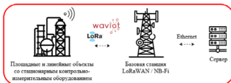
Рисунок 3. Беспроводная передача данных по технологии NB-Fi/LoRaWAN.
