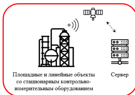
Рисунок 5. Беспроводная передача данных через низкоорбитальные спутники.
