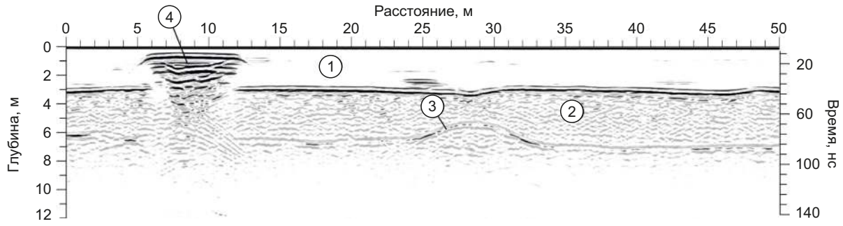
Рис. 11. Радарограмма по одному из профилей площадки № 2: 1 – лед; 2 – аллювий мерзлый; 3 – граница промерзания; 4 – локальная аномалия внутри льда.
