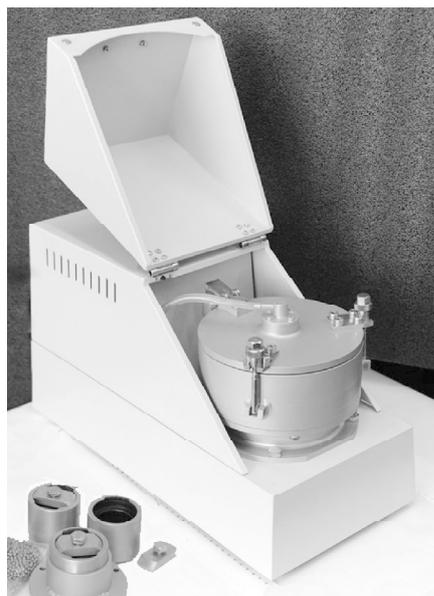
Рис. 5. Шаровая мельница активаторного типа для получения высокодисперсных порошков
