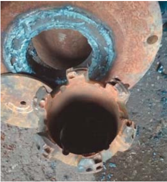
Рисунок 1 — Долото после разбуривания (слева на рисунке — долото после разбуривания, справа на рисунке — продукты разбуривания)
