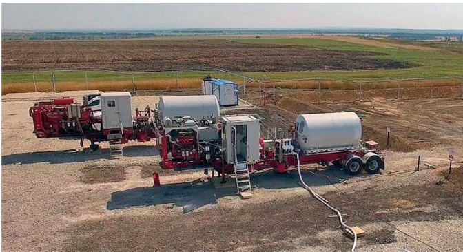
Рисунок 2 — Мобильный газовый насосный агрегат для закачки \text{CO}_2
