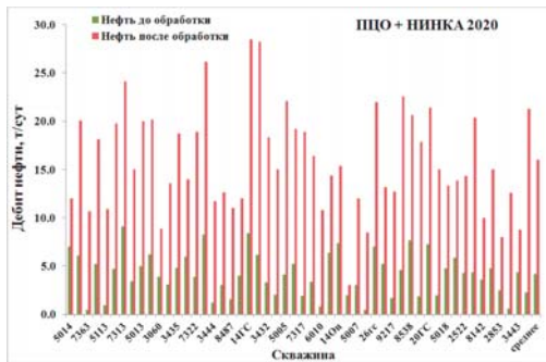
Рисунок 2 — Увеличение дебита нефти после закачки композиций НИНКА® при пароциклической обработке скважин на пермокарбоневой залежи высоковязкой нефти Усинского месторождения в 2020 г.
