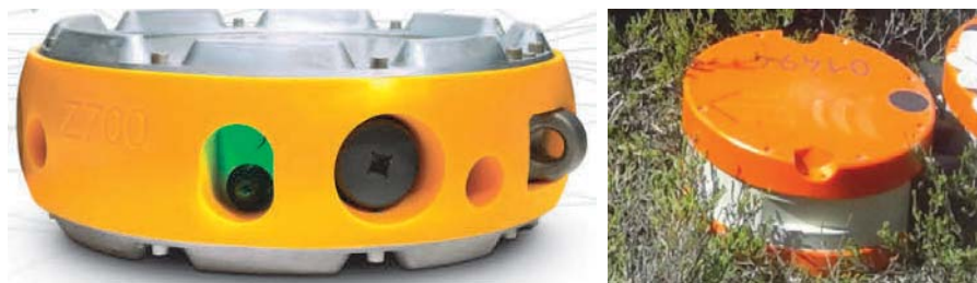
Рисунок 1 — Примеры автономных донных сейсмических станций
