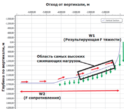
Рисунок 2 — Условие спуска обсадной колонны в горизонтальный интервал
