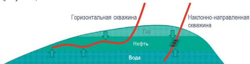
Рисунок 1 — Схематичное изображение прорывов воды и газа в горизонтальных и наклонно-направленных скважинах
