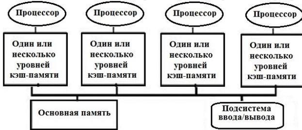
Рис. 21.1. Мультипроцессорная система с общей памятью.
