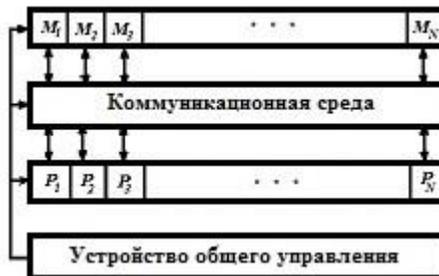
Рис. 18.6. Структура векторно-параллельного процессора с различным количеством скалярных процессоров и модулей памяти.
