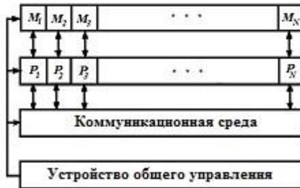
Рис. 18.5. Структура векторно-параллельного процессора с одинаковым числом скалярных процессоров и модулей памяти.
