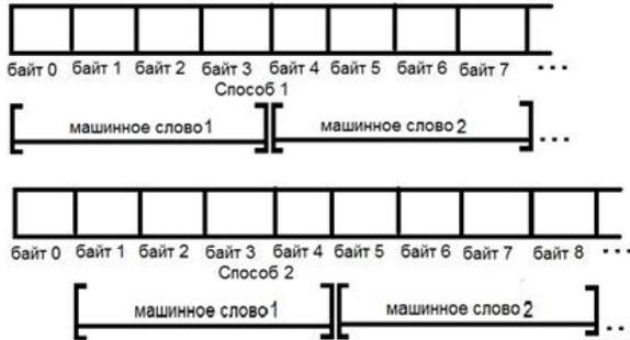
Рис.8.3. Способы размещения машинного слова
