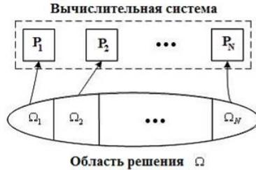
Рис. 18.8. К распараллеливанию на основе декомпозиции области решения  $\Omega$  на подобласти  $\Omega_i, i \in [1, N]$ .
