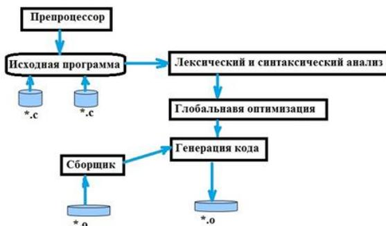
Рис. 2.2. Составные части процесса компиляции
