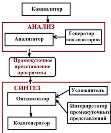
Рис. 2.1. Общая схема механизма трансляции.
