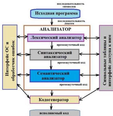
Рис. 3.2. Блок анализа процесса компиляции (АНАЛИЗАТОР)
