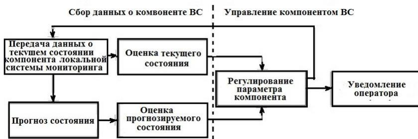
Рис. 22.1. Общая схема интеграции локальной системы мониторинга в состав системы мета-мониторинга
