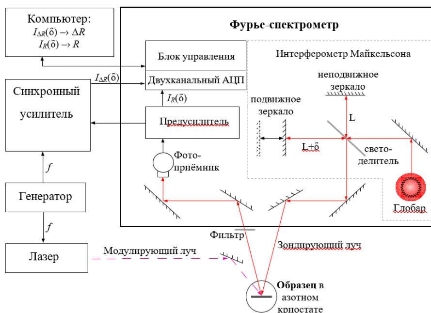
Рис. 1. Схема установки на основе фурье-спектрометра для измерения фотомодуляционных спектров отражения в среднем и ближнем инфракрасном диапазоне
