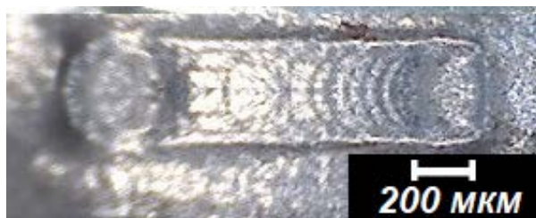
Рисунок 1 – Вид отпечатка полученного в импульсном режиме с постоянным коэффициентом заполнения импульса (0,5). На концах паза в области остановки и смены направления движения ЭИ наблюдаются большой съем металла.
