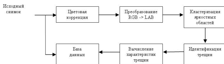
Рис. 1. Схема идентификации трещин на снимке объекта
