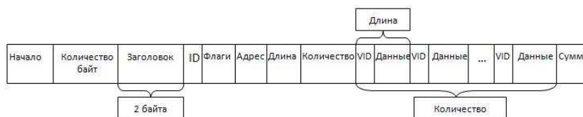
Рис. 1. Структура длинного пакета управления сервоприводами
