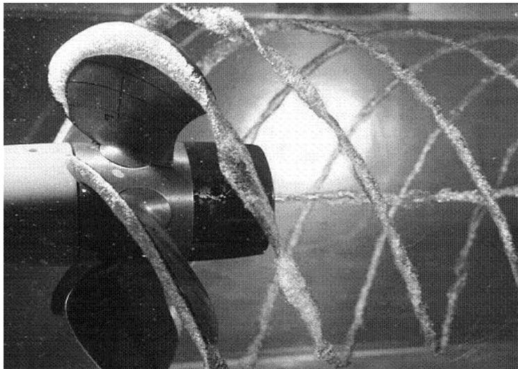
Рис. 1. Кавитация гребного винта.
