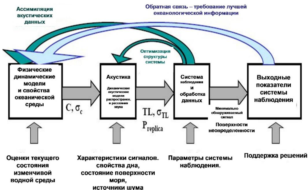
Рис. 2. Функциональные схемы акустического наблюдения с обратными связями от элементов наблюдения к системе оперативной океанографии и с обозначением распространения неопределенностей (стандартного отклонения « $\sigma$ » невязок модельных и натурных данных).
