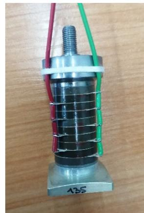
Рис. 2. Макет широкополосного стержневого пьезопреобразователя.
