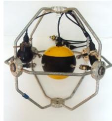
Рис. 4. НЧ интенсиметрический зонд.
