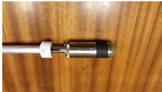
Рис. 2. ВЧ интенсиметрический зонд.
