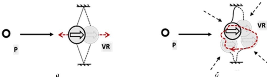
Рис. 2. Траектория перемещения векторного приёмника при воздействии тонально-импульсного сигнала (а) и в реверберационном поле (б).
