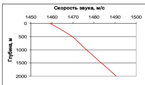
Рис. 1. Вертикальное распределение скорости звука.
