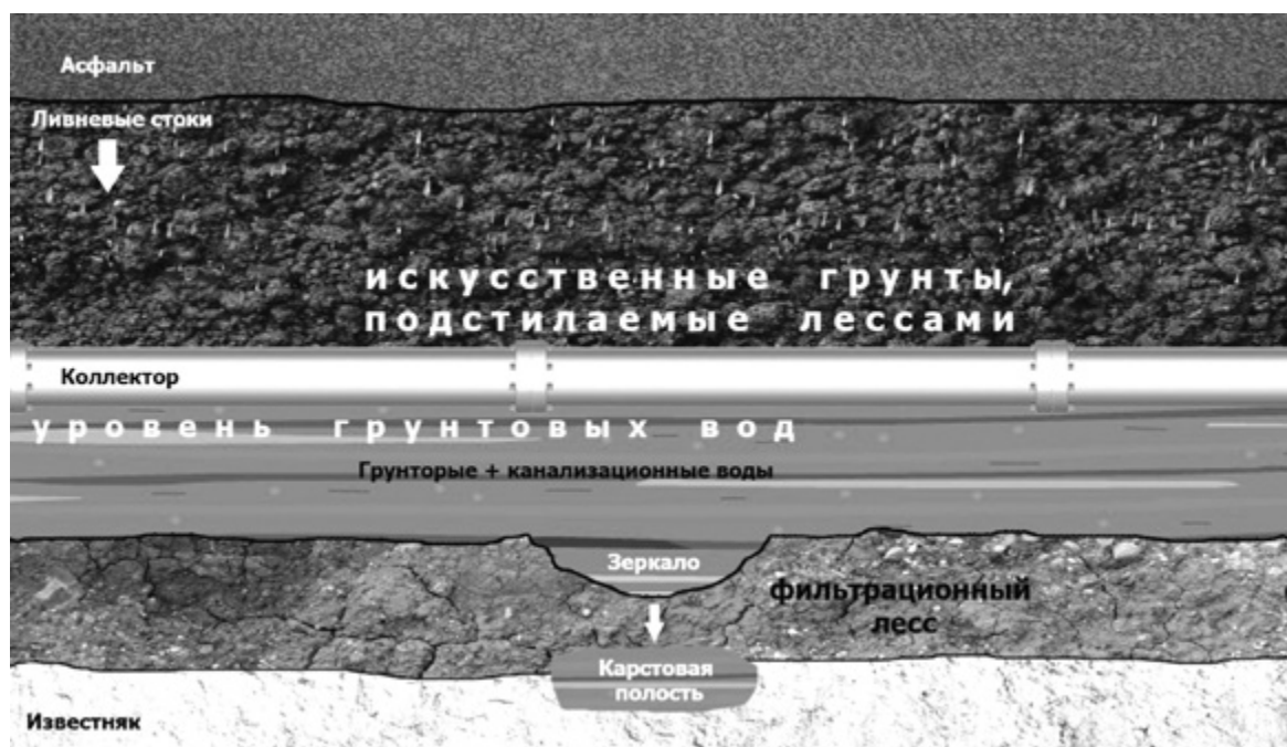
Рис. 1. Схема разрушения коллектора под влиянием гидрогеологических процессов
