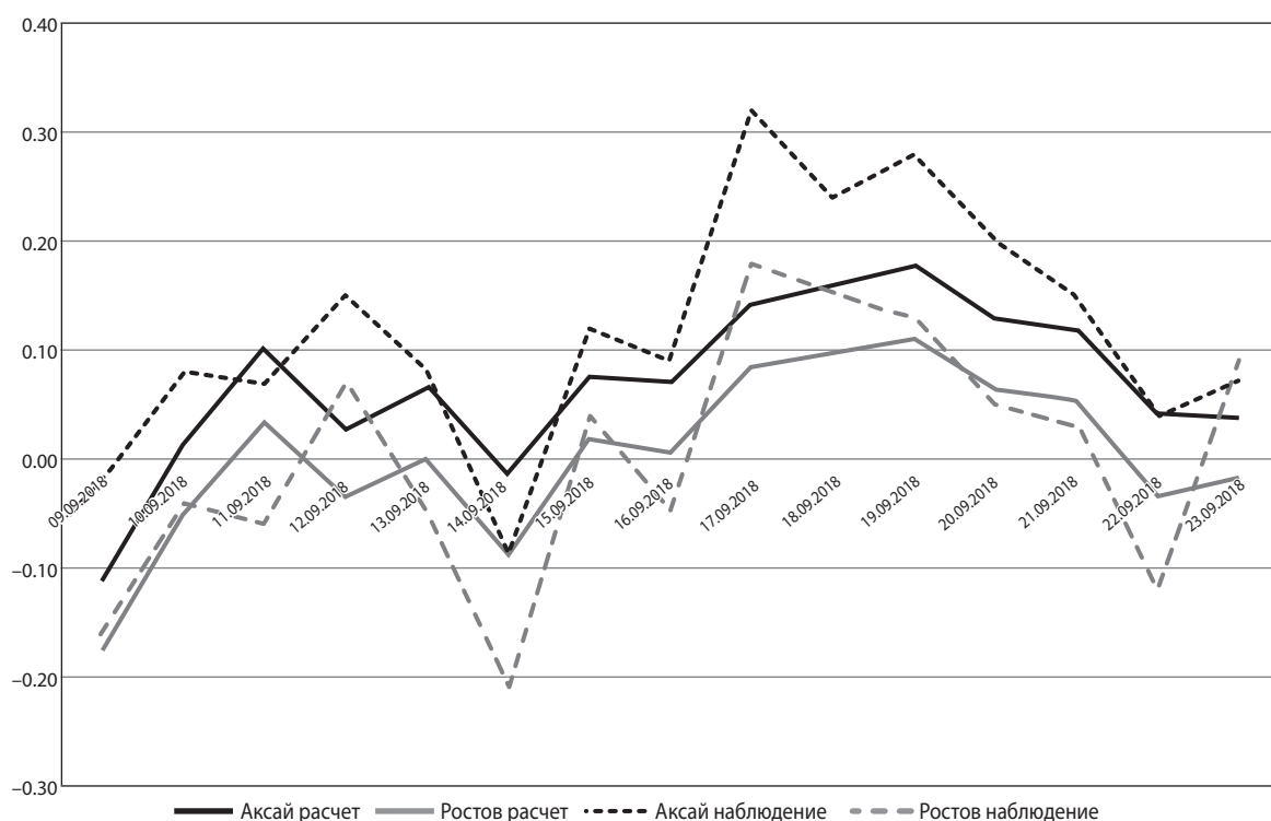
Рис. 3. Сравнение наблюдаемых и расчетных колебаний уровня воды на гидропостах в Ростове и Аксае (10–21.09.2018)
