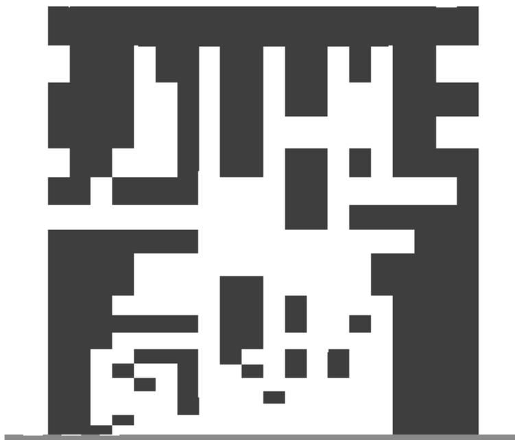
Рис. 3. Картина разрушения льдины перед плоским затвором при  $t=0.0128$ с. Модель 1
