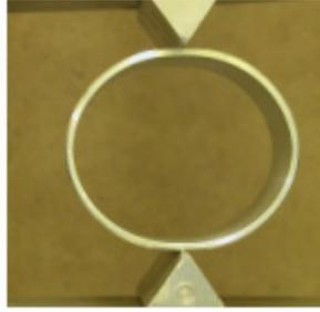
Рисунок 7. Сдеформированный образец
