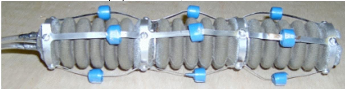
Рис. 2. Макет мини-робота, использующего перистальтический принцип движения.
