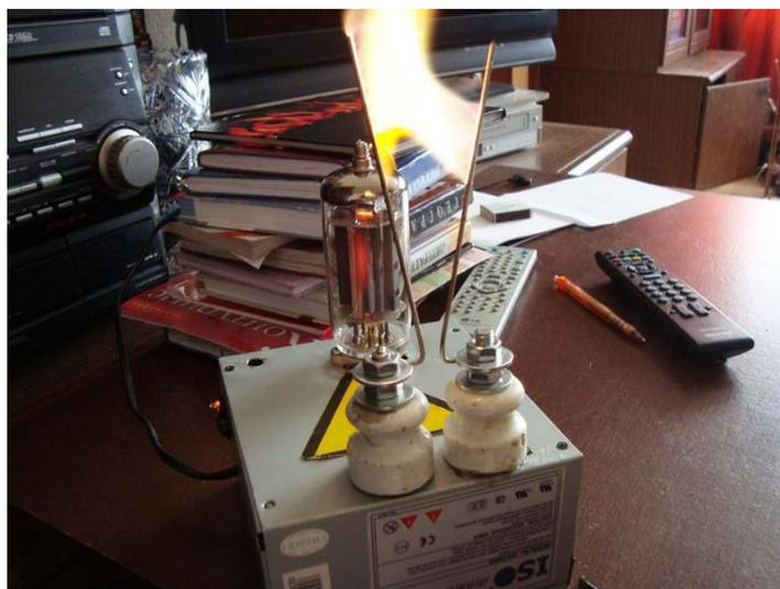
**Рис. 2. Ламповый автогенератор на пентоде 6П45С и строчном трансформаторе**
