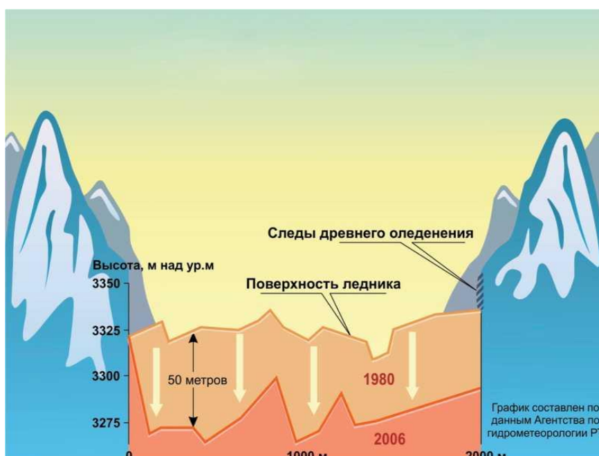
Рисунок 3. Оседание поверхности ледника Федченко. Съемка поперечного профиля [1].
