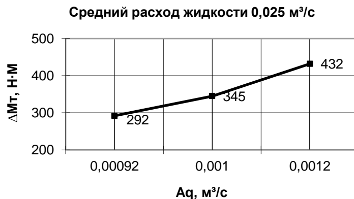
Рис. 1. График зависимости момента турбины турбобура от амплитуды колебаний промывочной жидкости
