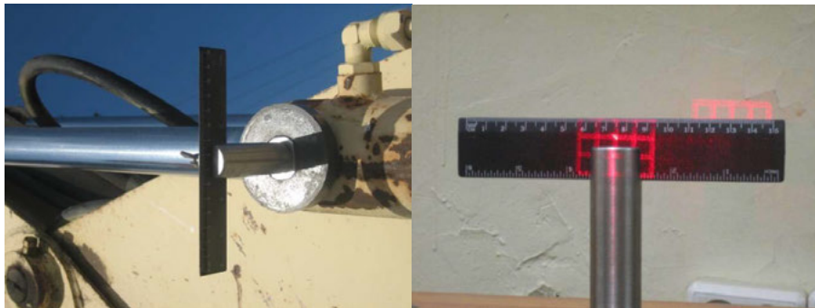
Рис. 2. Промежуточный приёмник на гильзе гидроцилиндра и проекция луча лазера на промежуточном приёмнике.
