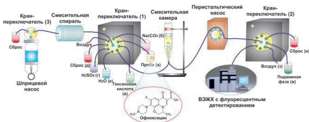
Рисунок 1. Гидравлическая схема для автоматизированного определения офлоксацина в гомогенных растворах
