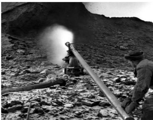
Рисунок 2. Гидравлический способ удаления покровных отложений на разрезе Бачатский
