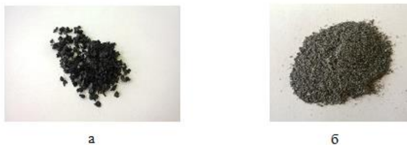
Рис. 1. Композиционные сорбционные материалы (КСМ): а – ФГШ + парафин (1:2) (КСМ-1); б – ФГШ + ПСМ-1 (1:2) (КСМ-2)
