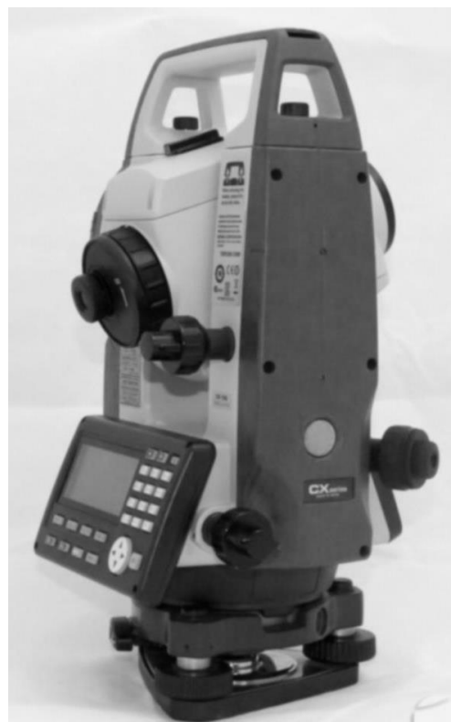
Рис. 1. Электронный тахеометр Sokkia CX-106
