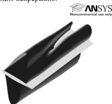
Рис. Очертания сверхзвуковых зон около сегмента крыла. Удлинение 3. Угол крутки  $3.6^\circ$ . Угол атаки  $-0.84^\circ$ .
