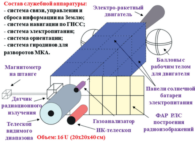
Рис. 7. Состав НОКА для дистанционного зондирования элементов космического мусора на низких орбитах
