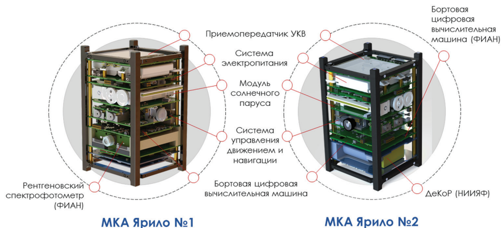
Рис. 4. Внутренняя компоновка пикоспутников «Ярило» № 1, 2
