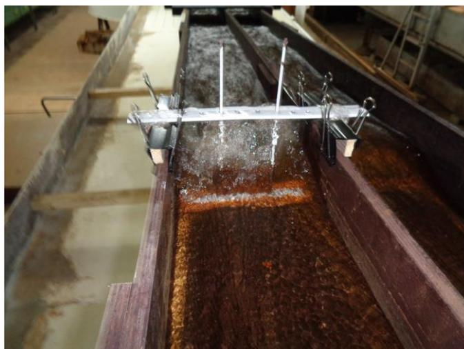
**Рисунок 7** – Модель в виде бычка прямоугольной формы
