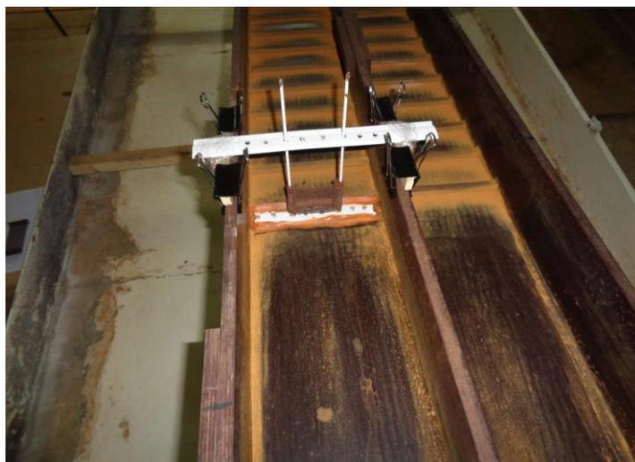
**Рисунок 4** – Модель сетчатой селезадерживающей конструкции в сборе
