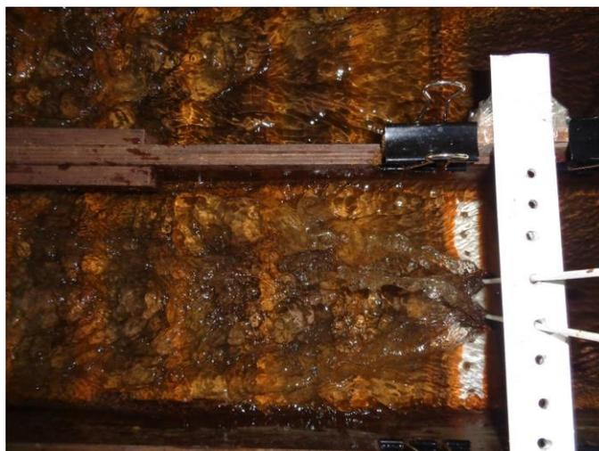
**Рисунок 8** – Протекание потока через барьер пролётом 2 см
