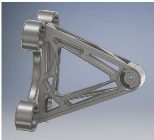
**Рисунок 6** – Оптимизированная форма кронштейна
