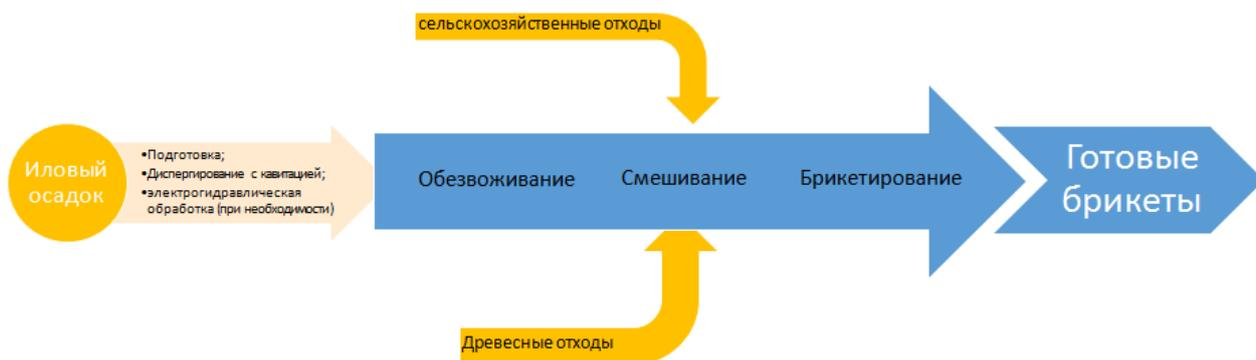
**Рисунок 1** – Последовательность операций получения брикетированного *MSF*-топлива
