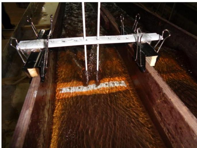
**Рисунок 6** – Модель в виде бычка криволинейной вогнутой формы
