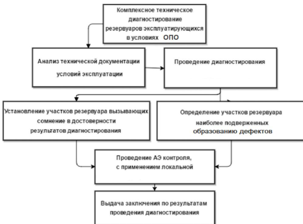
**Рисунок 1** – Алгоритм проведения ТД резервуаров с применением, на ответственных участках, нагружения при АЭ контроле
