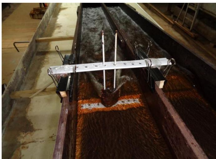
**Рисунок 5** – Модель в виде бычка полуциркульной формы
