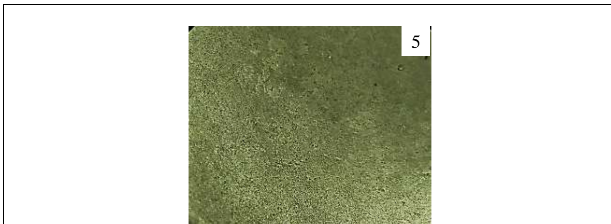
Рисунок 2 - Результаты микроструктурного анализа сплавов системы Al-In эвтектического состава, легированного празеодимом (соответствует таблице 1).
