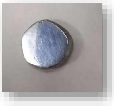
Рисунок 1 - Поверхность шлифа сплавов системы Al-In-Pr , подготовленная для микроструктурного анализа.
