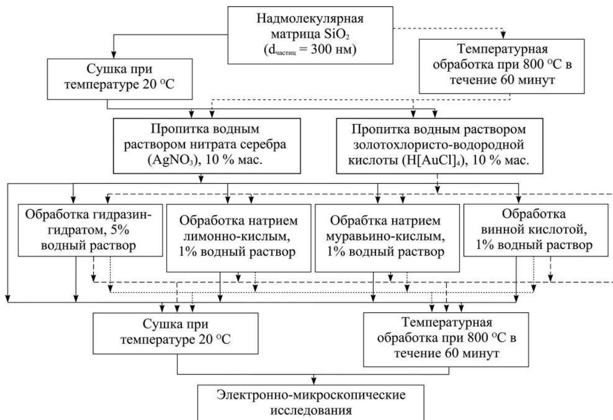
**Рис. 1.** Схема проведения эксперимента по получению нанокompозитных материалов на основе надмолекулярных матриц кремнезема и соединений Au и Ag
