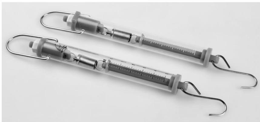
Рис. 37. Пружинные динамометры
