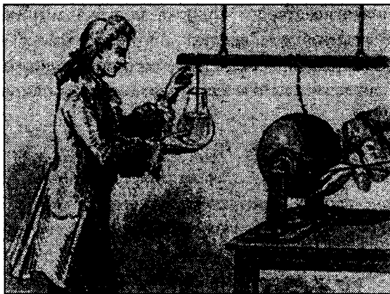
Рис. 2. Опыт Мушенбрука с лейденской банкой — электризация воды от электрической машины (стеклянный шар этой машины электризовался трением его о ладони рук) [41]
