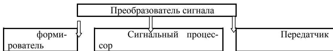
Рис.3. Построение ИС: преобразование сигнала от детектора с передачей данных на устройство отображения
