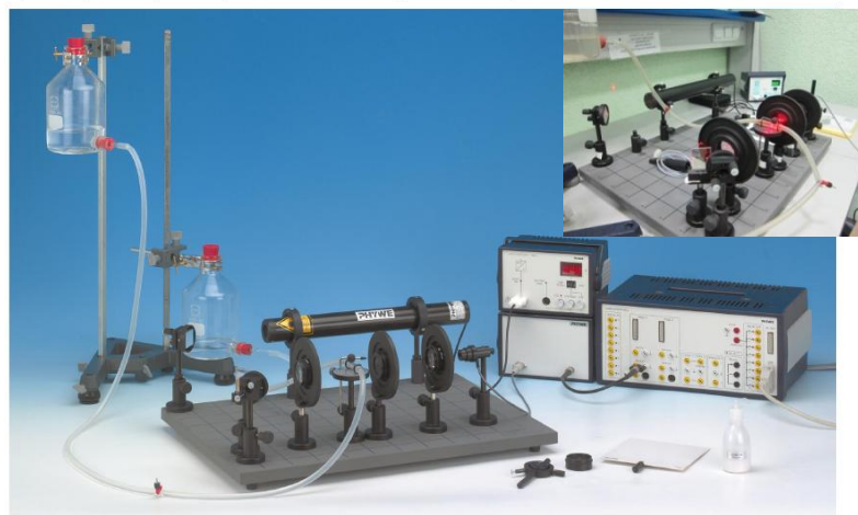
Рисунок 4 Экспресс технология измерения скорости движения жидких сред на основе оптического эффекта Доплера
