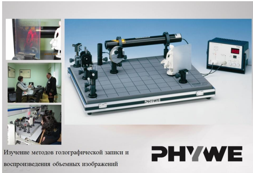
Рисунок 3 Технология создания и восстановления фазовых голограмм с источниками естественного и когерентного излучения.
