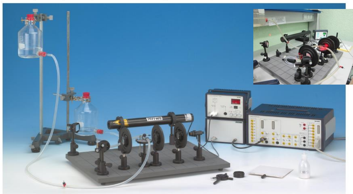
Рисунок 4 - Экспресс технология измерения скорости движения жидких сред на основе оптического эффекта Доплера.
