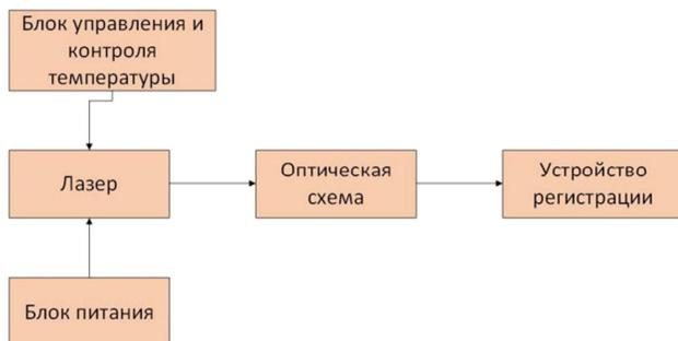
Рисунок 2. Схема экспериментальной установки
