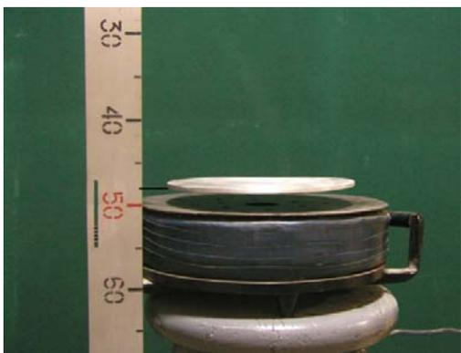
Рис. 3 . «Парение» диска из чистого алюминия (высота подъема  $x = 25$  мм)
