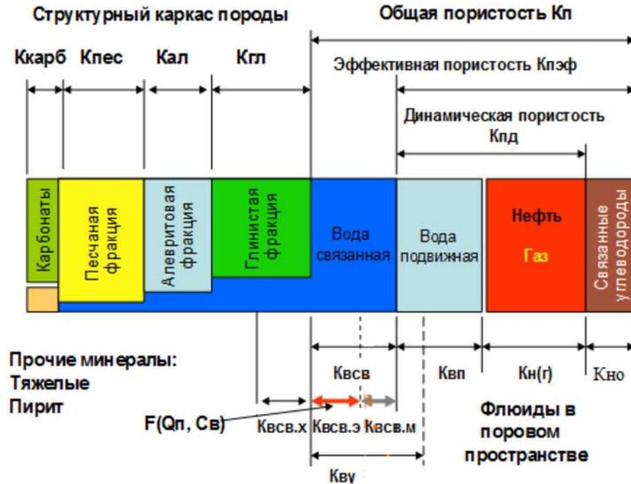
Рис. 1. Схема трехкомпонентной модели терригенной породы
