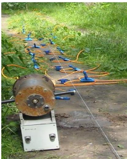
*Рис. 1.* Излучатель и сейсмокоса
