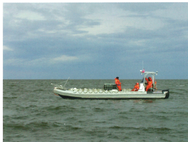
▲ Рис. 3. Постановка донных модулей с моторной лодки
