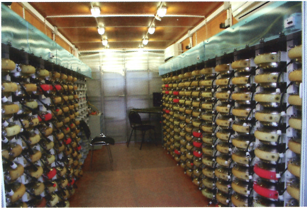
▲ Рис. 2. Мобильный сейсмический комплекс с донными модулями «Turtle-500»
