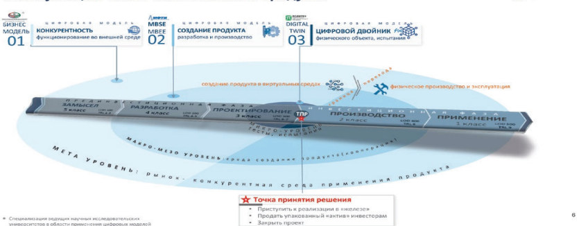
Рис. 4. Цифровые модели на этапах ЖЦ создания и эксплуатации технически сложного продукта [6]
