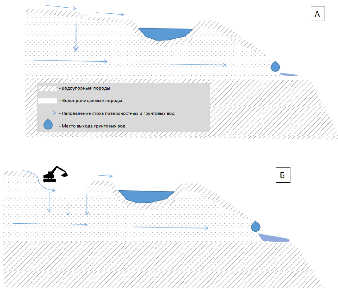
Рисунок 11 - Возможный механизм влияния срытия грунтов на водоразделе на дебит родников. А - первоначальные условия, Б - текущие условия
