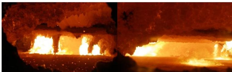
Рисунок 1 - Настыли в печи взвешенной плавки на входе в аптейк
