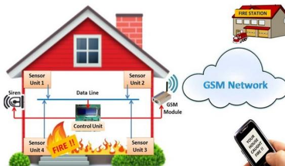
Рисунок 1- Схема системы пожарной сигнализации
