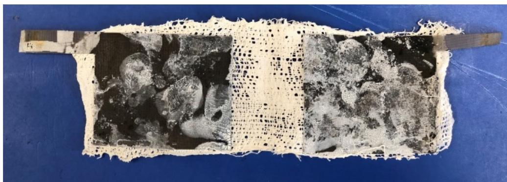
Рис. 1. Внешний вид химически-сшитого полимерного электролизера
