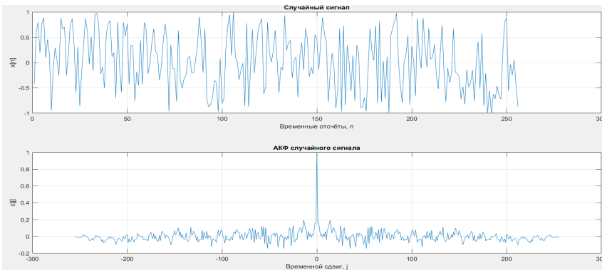
Рисунок 6. – Определение периодичности случайного сигнала.
