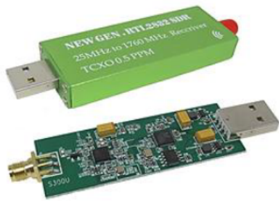
Рисунок 11 – RTL-SDR USB тюнер на базе микросхемы RTL2832U.
