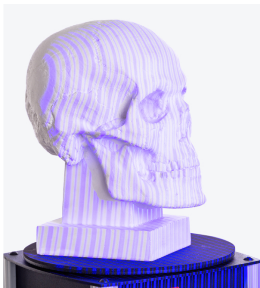
Рисунок 7 – Структурированный подсвет. Паттерны
