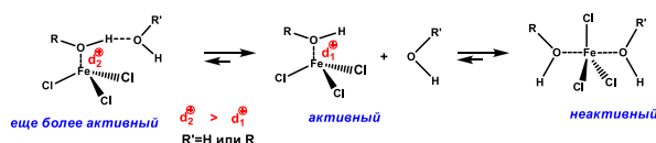
Рис. 1 – Упрощенная схема активирующего действия воды.
